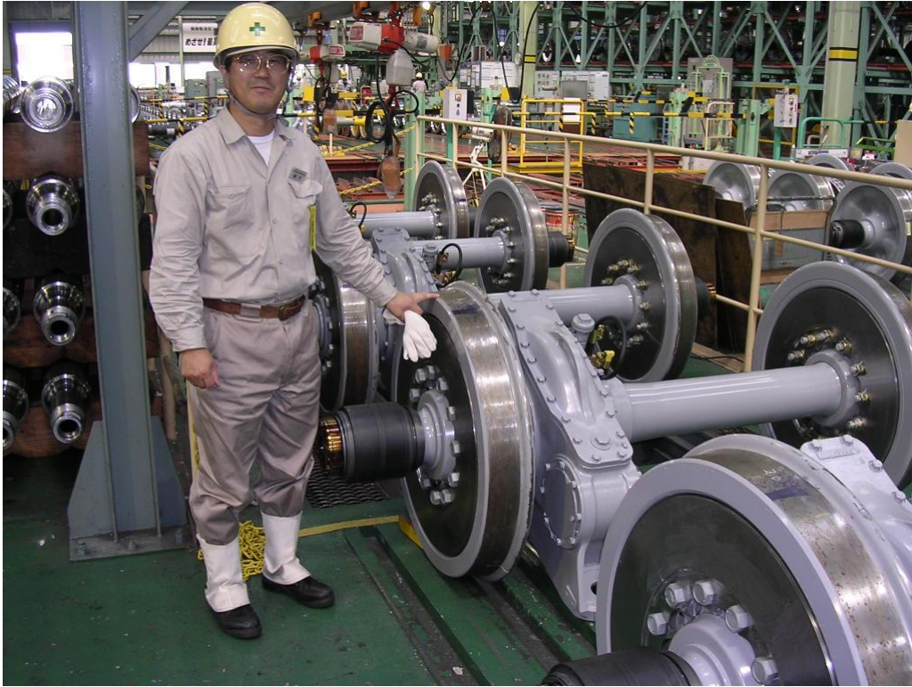
職場での写真です。製品はJR東海新型新幹線N700の輪軸です。 最高速度300km/hで走ります。
